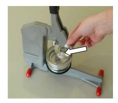
2. Colocar la parte delantera de la chapa en el interior del molde.
