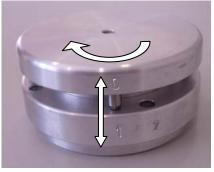
**5.** Colocar el cabezal sobre el molde, haciendo coincidir en línea la marcas "0 / 1 / 1".
